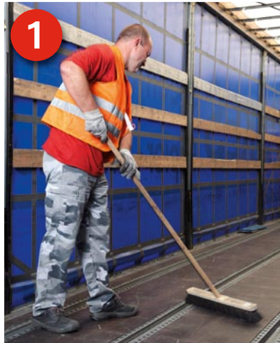
1 Voraussetzung: Verwenden Sie ein geeignetes Fahrzeug (DIN EN 12642 CodeXL) und fegen Sie die Ladefläche besenrein.
